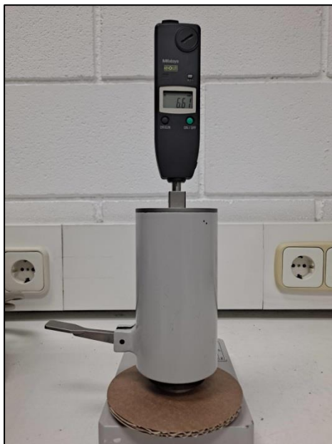
Fotografía 8. Determinación del espesor de cartón ondulado
