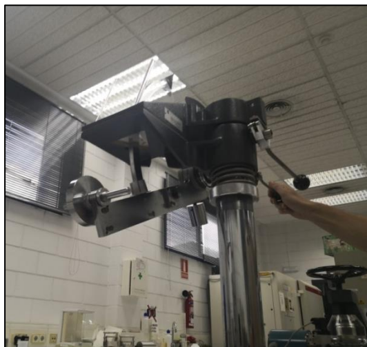
Fotografía 10. Prueba de determinación de la resistencia a la perforación
