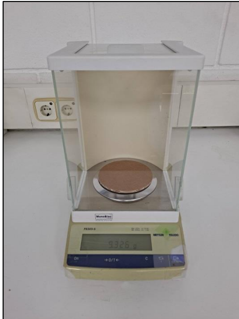
Fotografía 7. Determinación del gramaje
